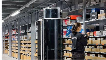
Wenn Menschen und Roboter die gleichen Gänge zur Kommissionierung nutzen, ist es zur Reduzierung von Wartezeiten erforderlich, dass sie einander passieren lassen können. Bei der optimalen Gestaltung der Gangbreiten sind weiterhin die geltenden Sicherheitsregelungen zu berücksichtigen, so dass dem Roboter auch eine schnelle Fahrt im Gang ermöglicht werden kann.
